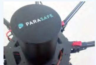
ドローンに載った実際の安全装置
