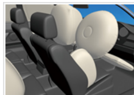
火薬の技術により作動するエアバッグ
