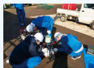
フィールドに出て繰り返し行うドローンの飛行、落下テスト
