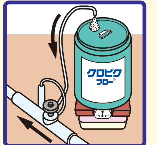
液肥混合器のコックを事前に調節した位置まで投げ投薬を開始し、同時に通水を開始します。通水後、投薬量を微調整します。
