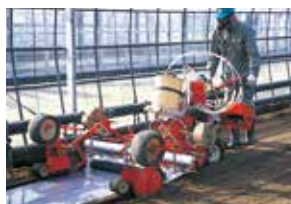
全面マルチ土壌消毒機 薬液注入と同時にシートによる被覆ができます。
