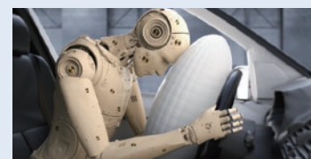
インフレーターは衝突時のエアバッグを膨らませるためのガスを瞬時に発生させる
