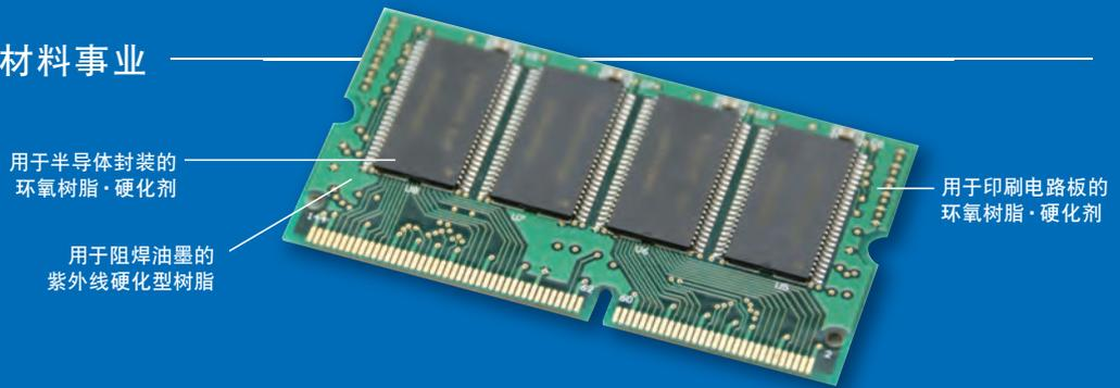
在功能性材料事业方面,半导体封装用绝缘材料的环氧树脂、彩色防染材料、阻焊材料、硬质涂层等,被广泛应用于各领域的紫外线硬化型树脂,以及以高耐热·高耐久性见长的聚酰亚胺、聚酰胺树脂等,涉及备有各种功能的材料。特别是环境对应型的环氧树脂,在要求非卤素的半导体封装材料、电子基板材料方面,构筑起事实上的业界标准之地位。
