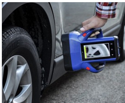
携帯型X線後方散乱イメージング ※Viken detection社より許可を得て掲載しています。
