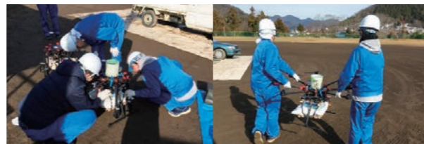
フィールドに出て繰り返し行うドローンの飛行、落下テスト
